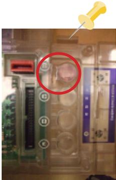
(d) 固定部分を切り離したら、ピンマーク部分を押上げてメイン基板ケースを手前に引いて取り外します。
