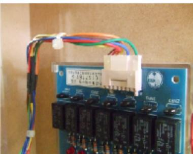
(g) 集中端子部分に、(f写真内の赤枠部分コネクタを差し込みます。
