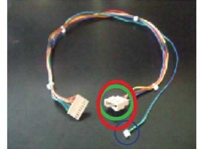
(f) 装着するデータランプ中継ハネース及び電磁カウンター用配線。
